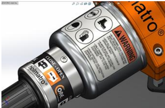
圖 3-1. SOLIDWORKS 所設定之貼圖
